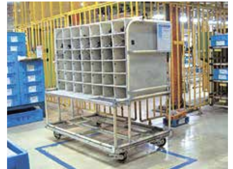
Carro del embarque portátil para puertas del cierre MOVING CART FOR DOOR LOCK
